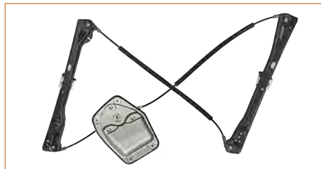
ELEVADOR ELECTRICO 1K3837462A
