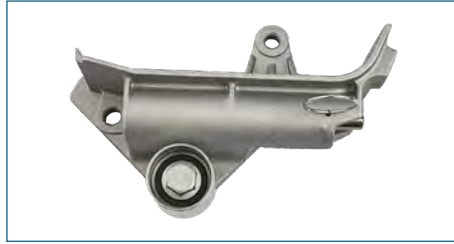
TENSOR DISTRIBUCION 06B109477
