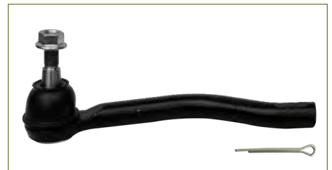
TERMINAL DIRECCION D8520JA00A TERMINAL DIRECCION ALTIMA (2007-2012) 2.5, 3.5 - MAXIMA (2009-2014) 3.5 - MURANO (2010-2014) 3.5 / (DERECHA)
