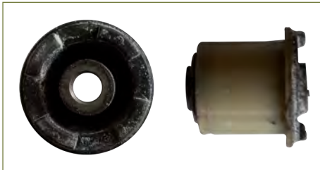
BUJE HORQUILLA 90468638 BUJE HORQUILLA ASTRA (2000-2005) 1.8 / (TRASERO)
