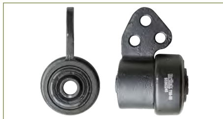
BUJE HORQUILLA 93302245 BUJE HORQUILLA CORSA (2002-2009) 1.8 - MERIVA (2006-2008) 1.8 - TORNADO (2003-2019) 1.8 / (CON OREJA-GRANDE)
