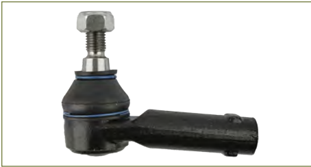
TERMINAL DIRECCION 701419812D-EURO TERMINAL DIRECCION EUROVAN T4 (2001-2004) 2.5 / (DERECHO)
