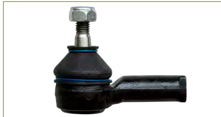
TERMINAL DIRECCION 93296756-EURO TERMINAL DIRECCION CHEVY (1995-2012) 1.6 / (DERECHA IZQUIERDA-DIRECCION ESTANDAR)
