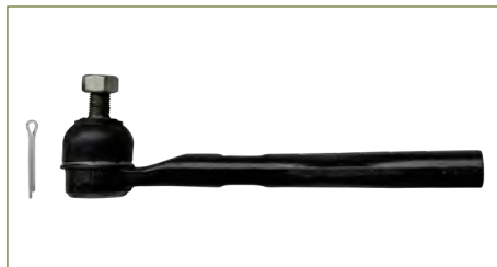
TERMINAL DIRECCION 53560TBAA01 TERMINAL DIRECCION CIVIC (2016-2021) 1.5T, 2.0/ (IZQUIERDO)
