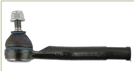
TERMINAL DIRECCION 48640ET00A TERMINAL DIRECCION SENTRA B16 (2006-2012) 2.0, 2.5 / (IZQUIERDA)
