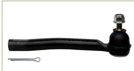
TERMINAL DIRECCION D85203SG1A TERMINAL DIRECCION SENTRA B17 (2013-2019) 1.6T, 1.8 - JUKE (2011-2017) 1.6T - KICKS (2016-2021) 1.6 / (DERECHA)
