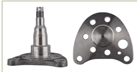
MUÑON 333501118 MUÑON EJE TRASERO JETTA III (1993-1999) 1.8, 2.0 - GOLF III (1993-1999) 1.8, 2.0 - JETTA IV (1999-2015) 2.0 - GOLF IV (1999-2007) 2.0 / (ARBOLITO-TRASERO DERECHA) (FRENO A DISCO EN RUEDA)
