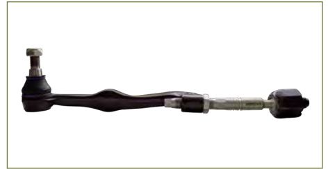
VARILLA DIRECCION 7H0419803D-EURO VARILLA DIRECCION EUROVAN T5 (2005-2008) 2.0TDI / (COMPLETA-IZQUIERDA)
